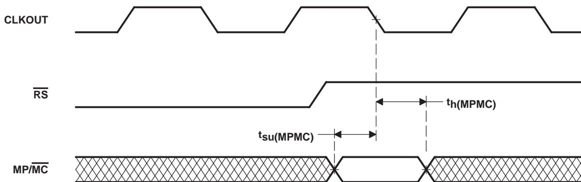
Figure 24.  $\text{MP}/\overline{\text{MC}}$  Timing
