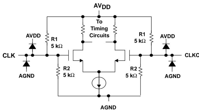
Figure 20. Clock Inputs
